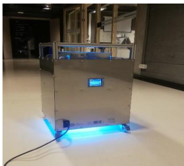
13. attēls UV dezinfekcijas iekārta darbībā
