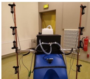
12. attēls Dezinfekcijas smidzinātājs uz mobilā robota
